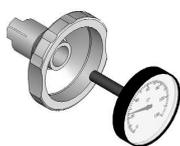
Насосная группа укомплектована термометрами в подающей и обратной линиях, что позволяет оценить температурный перепад в контуре(1, 2). В случае необходимости замена термометра производится путем извлечения пластиковой рукоятки шарового крана вместе с термометром путем вытягивания «на себя», без прерывания работы системы.
